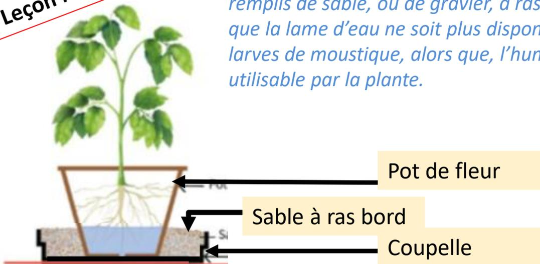
**Schéma de mise en place de sable dans une coupelle**
